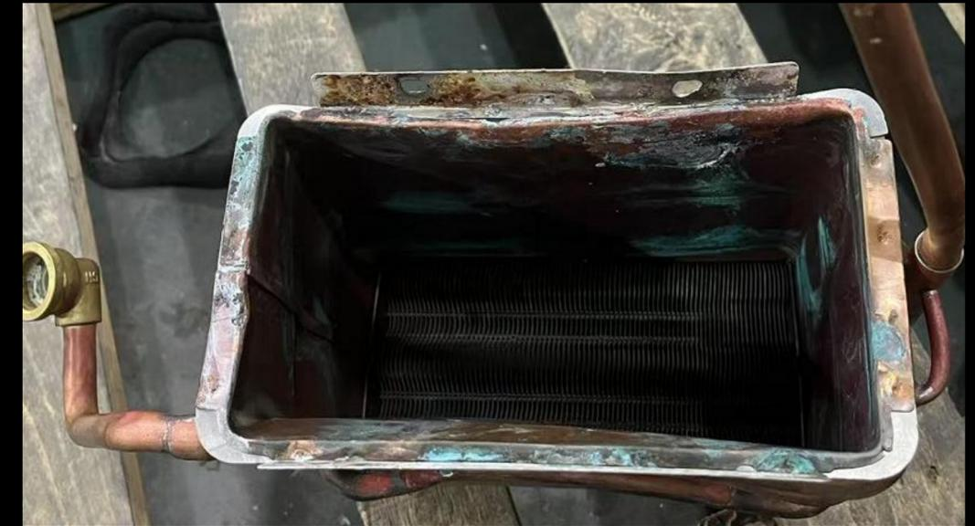
无氧铜水箱，面对水质较差地区，长时间使用后容易产生腐蚀，进而漏水
